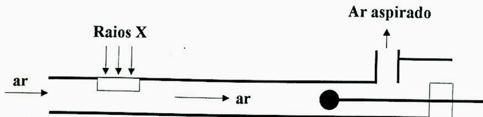
Fig. 1 – Esta figura, elaborada pelo tradutor a partir da descrição do artigo, mostra o dispositivo utilizado por Röntgen para estudar o efeito de descarga produzido pelo ar irradiado.
