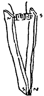
Figura 21 – Pinça formada por dois ímãs: obtenção de corrente induzida pela ação de um ímã permanente.
