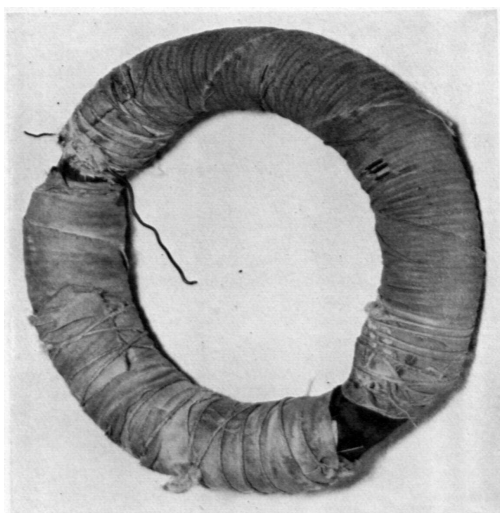
Figura 18 – Foto do anel de ferro, utilizado nas experiências de 1831.
